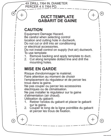
Fig. 4. Positioning return air duct template.
