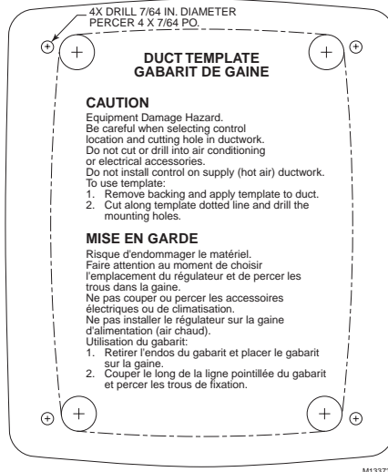
Fig. 4. Positioning return air duct template.
